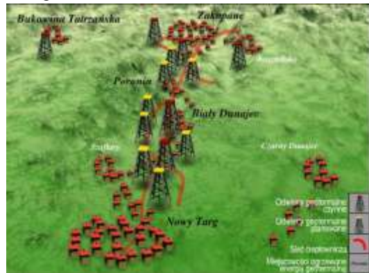
Ubicación de los pozos geotérmicos en el valle de Podhale. Barrenos rojos: pozos existentes; barrenos amarillo: pozos previstos
